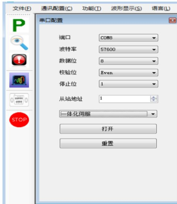
图 2 伺服调试软件之串口设置
